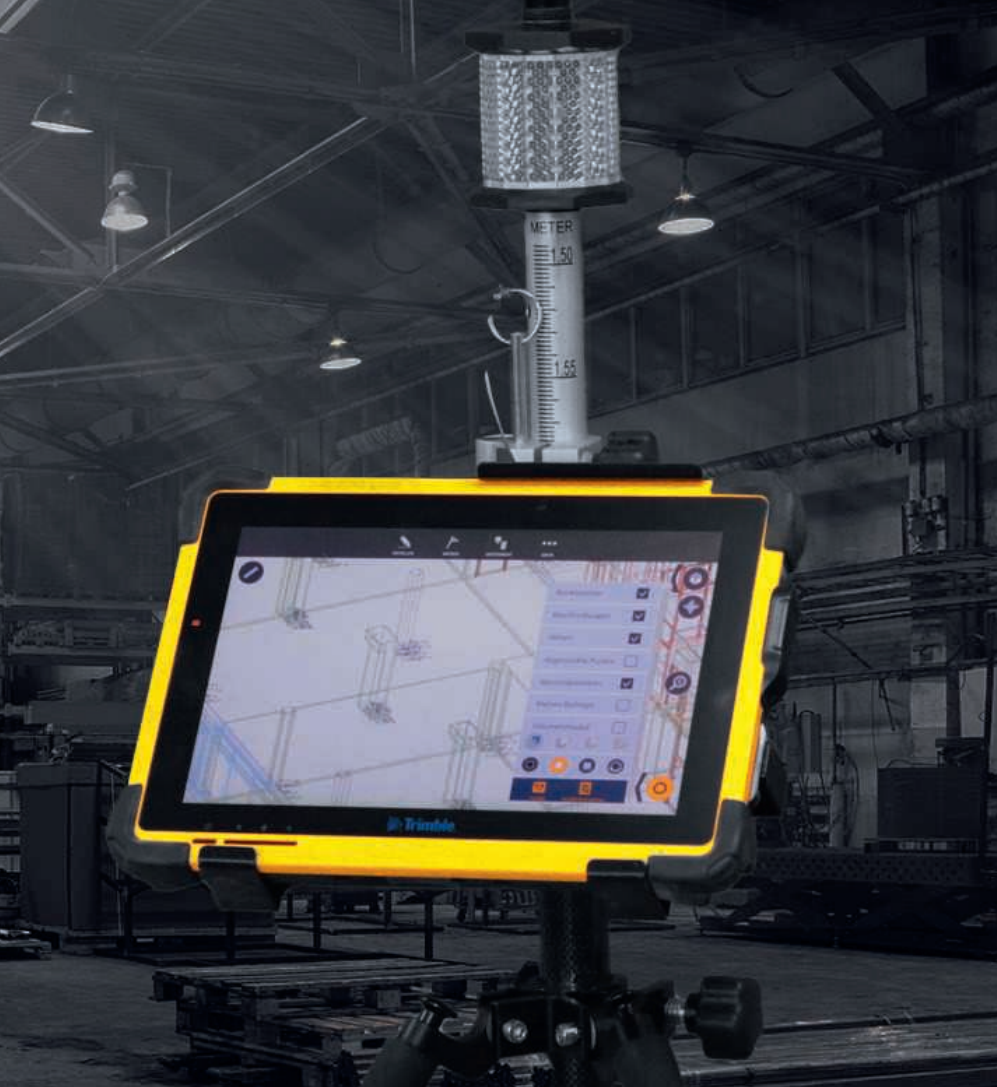
Der Tachymeter überträgt die virtuellen Bohr- und Befestigungspunkte auf das physische Objekt.
